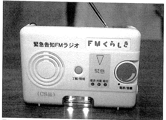
緊急告知FMラジオ。アナログ方式で故障がほとんどない。重さは480gと軽く、サイズは縦11cm、横16cm、奥行き5cm
